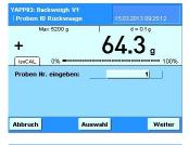
Nach Betätigen der Rückwaage Schaltfläche erfolgt die Aufforderung eine Proben Nummer einzugeben.
