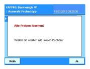
... erfolgt eine Betätigungsabfrage. Wird diese mit Ja bestätigt, werden alle im Speicher der Waage abgelegten Proben gelöscht.
