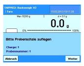
Nach Betätigen der Einwaage Schaltfläche erfolgt die Aufforderung eine Probenschale aufzulegen. Das Taragewicht wird bei Betätigen der Weiter Schaltfläche übernommen und die Anzeige auf Null gesetzt.
