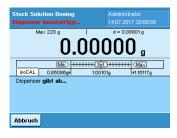
Das Lösungsmittel wird automatisch der Probe hinzugefügt. Während des Dispensierschritts wird dem Anwender die Meldung "Dispenser gibt ab" gezeigt.
