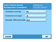
Chromeleon™ Anwender müssen die Chromeleon™-Kontrolle des Cubis Dosing Systems aktivieren. Chromeleon™-Kontrolle ermöglicht es der Software Daten an die Waage zu senden und abzuholen.
