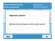
Für den Hamilton Dispenser speichert YAPP16 ob a) das Instrument richtig geprimed wurde, um frei von Luftblasen zu sein und die Spritze zu befüllen und ob b) die Restmenge an Lösungsmittel in der Spritze ausreicht, um den nächsten Dispensierschritt ausführen zu können. Wenn das nicht der Fall ist, wird dem Anwender eine Meldung mit der Frage angezeigt, on das System geprimed werden soll.
