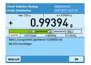
Pipettieren Sie die benötigte Menge Lösungsmittel zur Probe und bestätigen Sie mit "OK".
