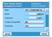
Der Name und die Dichte des Lösungsmittels werden aus der Datenbank geladen. Die Temperatur kann durch den Anwender verändert werden. Optional können eine Chargennummer und ein Kommentar für das Lösungsmittel eingegeben werden.
