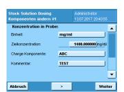
Der Name der Komponente, das Molekulargewicht, die Einheit und die Zielkonzentration werden aus der Datenbank geladen. Der Anwender kann die Probeninformationen bei Bedarf ändern und optional eine Chargennummer und einen Kommentar für die Komponente eingeben.
