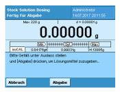
Jetzt ist der Dispenser bereit das Lösungsmittel zur Probe zu geben. Der Anwender muss die ein Probengefäß unter den Auslass stellen und dann die Taste "Abgabe" drücken.
