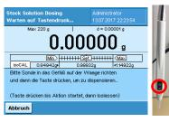
Jetzt ist der Dispenser bereit das Lösungsmittel zur Probe zu geben. Der Anwender muss die Sondenspitze in das Probengefäß richten und dann die Taste der Sonde drücken.
