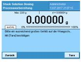
Platzieren Sie ein geeignetes Gefäß auf der Waagschale und drücken Sie "Tarieren", um die Waage zu tarieren.
