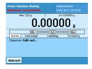
Während des Befüllungsprozesses zeigt die Applikation dem Anwender die Meldung "Dispenser füllt auf…". Der Dispenser stoppt automatisch, sobald der Befüllungsprozess abgeschlossen ist.
