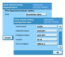
Für den Hirschmann opus Dispenser müssen das Volumen und die Geschwindigkeit festgelegt werden. Drücken Sie "Konf." im Auswahlbildschirm für Geräte. Die Geschwindigkeit kann zwischen 1.000 µl/s und 10.000 µl/s gewählt werden. Die maximale Geschwindigkeit unterscheidet sich für opus Dispenser mit unterschiedlichen Volumina:
