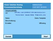
Drücken Sie "Start", um die ausgewählte Chromeleon™ Sequenz zu laden. Wenn eine Chromeleon™ Sequenz geladen ist, verwendet YAPP16 die in der Sequenz definierten Probennamen und gewünschten Konzentrationen. YAPP16 wiederholt automatisch die Wägeprozedur für jede Standardprobe, die in der Chromeleon™ Sequenz hinterlegt ist.
