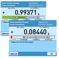
Wenn das gewogene Volumen dem Zielgewicht innerhalb der zulässigen Toleranzen entspricht, wird der Toleranzbalken in grün angezeigt. Wenn sich das gewogene Volumen außerhalb der zulässigen Toleranz befindet, wird der Toleranzbalken in rot angezeigt. Bestätigen das gewogene Volumen mit "OK".
