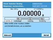
Bitte platzieren Sie ein Gefäß unter dem Auslass und drücken Sie "Abfall". Der Dispenser führt das Primen durch und dispensiert das im Kolben verbliebene Lösungsmittel in das Abfall-Gefäß.
