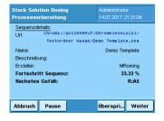
Der Fortschritt der Chromeleon™ Sequenz wird als Prozentwert angezeigt. Der Anwender kann mit der nächsten Probe weiter machen, eine Probe überspringen, abbrechen oder die Sequenz pausieren lassen.
