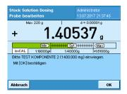
Für Mischstandards wird der Prozess solange mit dem Einwiegen der nächste Komponente fortgesetzt, bis alle Komponenten durch den Anwender eingewogen wurden.
