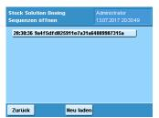
Um eine Chromeleon™ Sequenz zu öffnen, drücken Sie "Chromeleon Sequenzen öffnen" oder "Pausierte Chromeleon Sequenzen…" und wählen die Sequenz aus der Liste aus. Wenn die erwartet Sequenz nicht angezeigt wird, drücken Sie "Neu laden".
