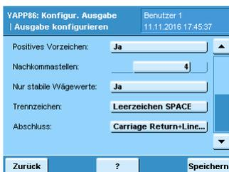
Die gewählten Einstellungen werden mittels „Speichern“ übernommen. Wird für die Länge der Wert -1 eingegeben, wird die Ausgabe vom System automatisch optimal konfiguriert.
