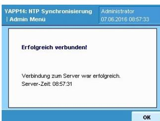
Über die Taste ‚Test‘ kann die Verbindung zum NTP Server überprüft werden. Hier wird lediglich die Verbindung überprüft eine Synchronisierung wird hier noch nicht vorgenommen.
