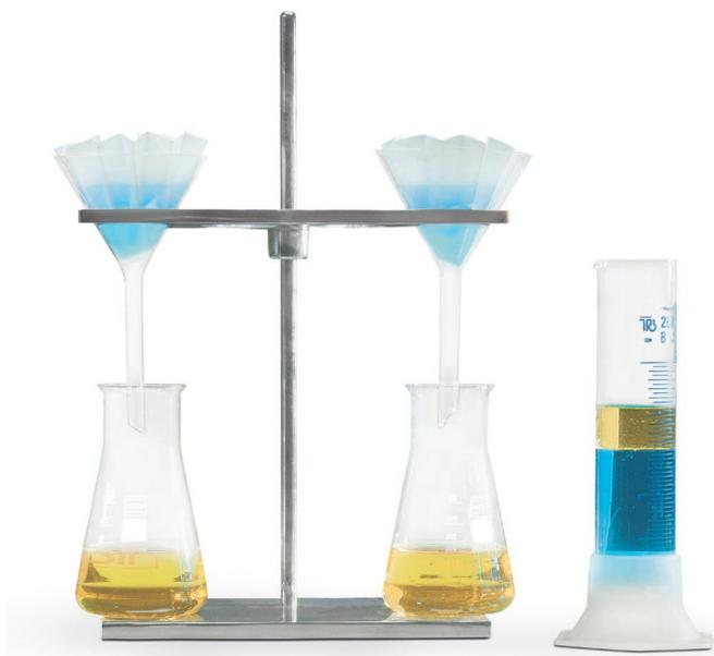
La carta di grado 480 è impregnata con silicone per renderla idrofoba: trattiene l'acqua ma lascia passare il solvente. Il flusso cessa automaticamente una volta che il solvente è passato completamente. In molte applicazioni questa carta può essere usata al posto degli imbuti separatori.
