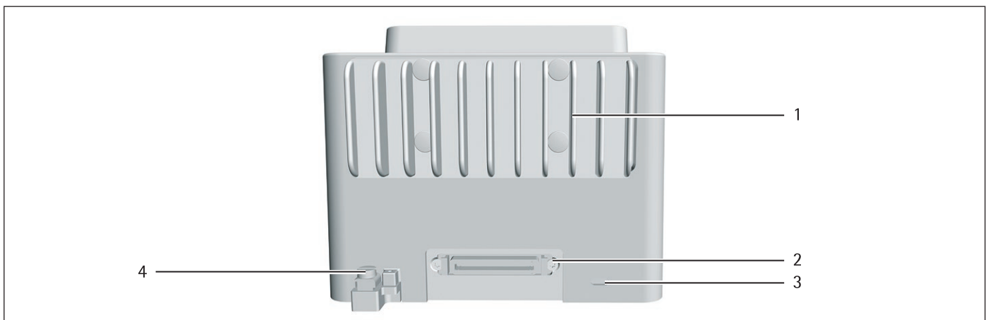
Abb. 4: Anschlüsse am Wägemodul der Mikrowaage (Beispiel)
